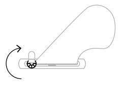
3. Zieh die Schraube durch leichtes drehen des schwarzen Kunststoffrad fest.
