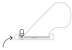
2. Dreh die Schraube um 90°. Stell sicher, dass der "Schraubenkopf" in einer Linie mit der Finne läuft.
