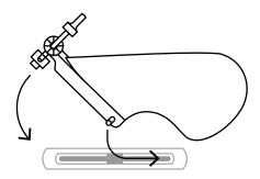
1. Schiebe die Finne über den Führungsstift in den Finnenkasten. Finne nach unten drücken, bis die Finnenbasis bündig mit der Oberkante des Finnenkastens abschließt.
